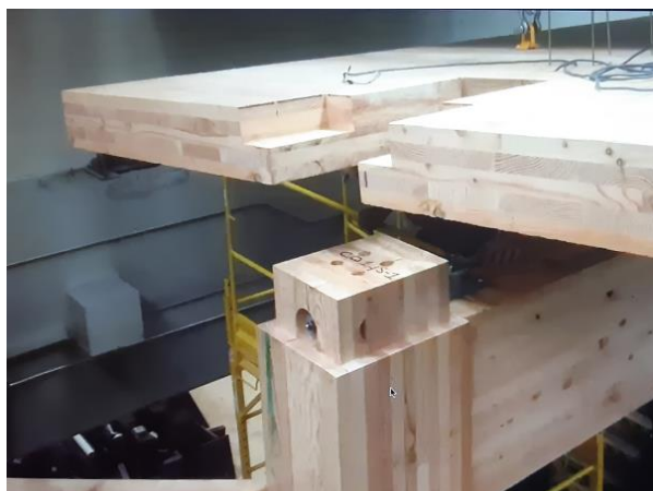
Rys.2. Metody połączeń paneli CLT
